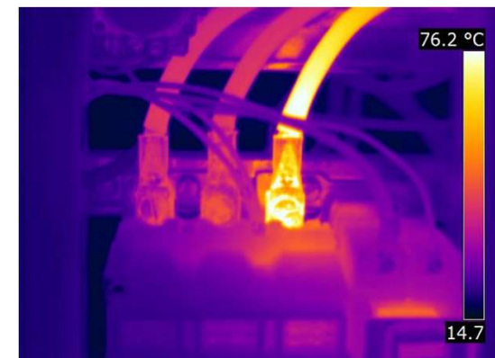
Sicherheitskritische Wärmeentwicklung durch fehlerhaften elektrischen Kontakt
