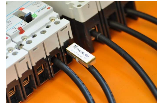
TempTagBLE-Tags mit Temperatursensor zur Überwachung elektrischer Kontakte
