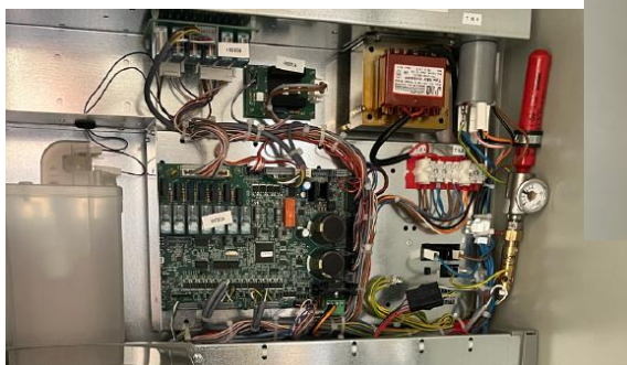
Beispielbild Die verbaute S-AMFE im Snackautomat
