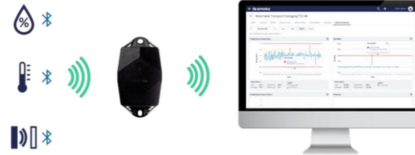
Zustandsüberwachung durch externe Sensoren über die Sensolus Plattform
