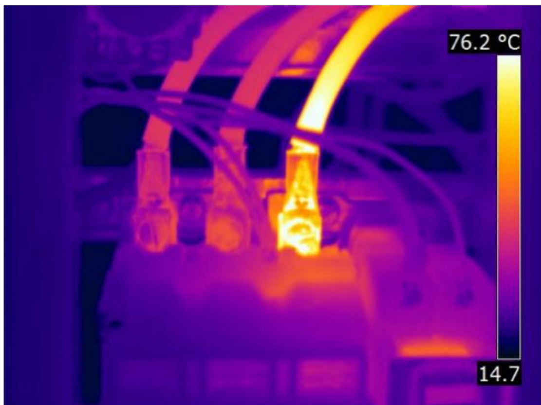
Sicherheitskritische Wärmeentwicklung durch fehlerhaften Kontakt
